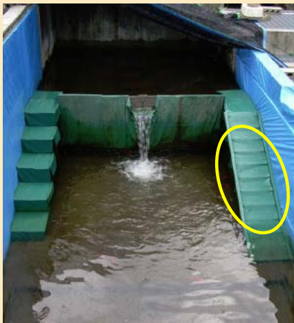
<斜路による遡上確認試験>
